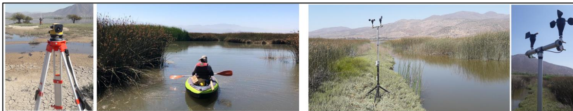
Figura N°7: Imágenes del levantamiento batimétrico y medición de vientos en la Laguna para el diseño del plan de manejo de pretilas
